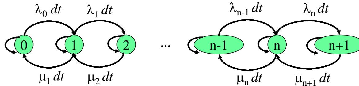
Por ser proceso de Poisson, la probabilidad de ocurrencia de un suceso en un  $\Delta t$  es proporcional a  $dt$  (llegada proporcional a  $\lambda_n \cdot dt$ , salida proporcional a  $\mu_n \cdot dt$ )
